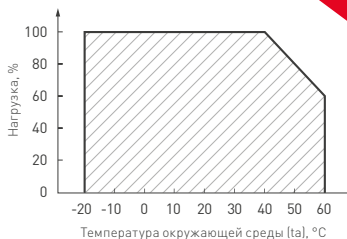
Рисунок 6. Максимальная допустимая нагрузка, % от мощности источника.
