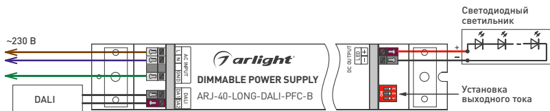
Рисунок 1. Подключение источника тока при использовании интерфейса DALI.
